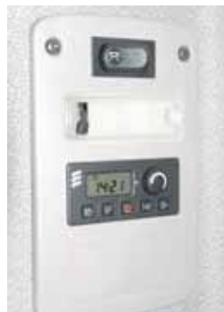
Eenvoudig Bij de DAF kan de kachel eenvoudig bediend worden vanaf het bed.
